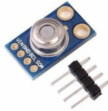
Fig. 8. Sensor infrarrojo MLX90614 empleado para la medición de temperatura corporal sin contacto.
